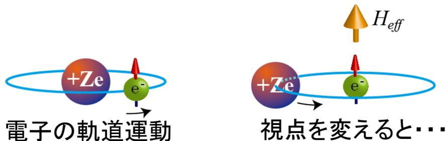
電子自身の軌道運動により発生する磁界がスピン磁気モーメントと相互作用する相対論的效果
