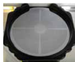
12"Siウェハによる X線望遠鏡レンズ
