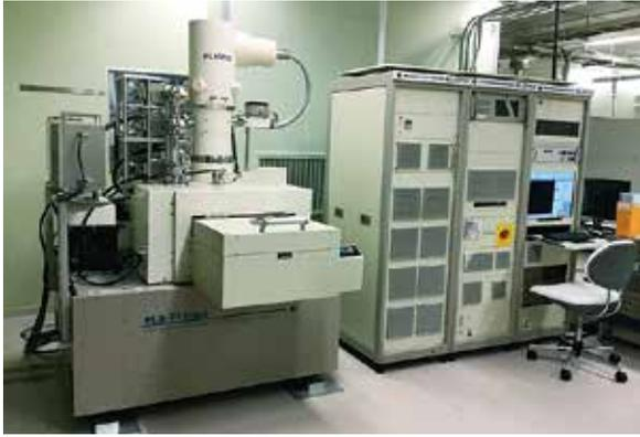
細く絞った電子ビームをレジストを塗布した基板に照射し、微細な露光パターン形成を行うための装置です。加速電圧が130 kVであるため非常に微細なパターン(5 nm)を描画することができます。最大スキャンクロック周波数が100 MHzであるため、高速描画が可能です。描画エリアは8 inchサイズですが、12 inch ウェハをセットすることが可能です。
