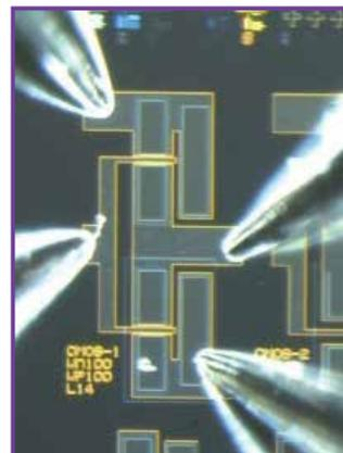
フルミニマルプロセスで作成したTiNゲートのCMOSFET作成期間は約1週間。
