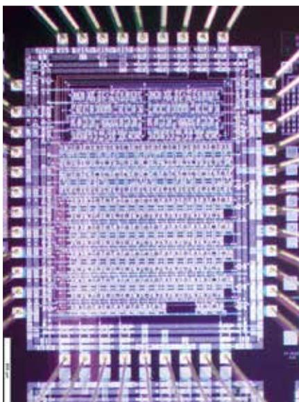
フルミニマルプロセスで作成した4ビットシフトレジスタ(Tr334個動作)。JAXA共同研究成果。設計から評価まで約半年で完了。
