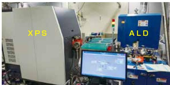
試料交換室を介してALD成膜装置に接続されているため、前処理による試料表面の自然酸化物除去の確認や、材料分子ガスの吸着解離の状態(ケミカルシフト)や膜組成のin-situ分析等が可能です。
