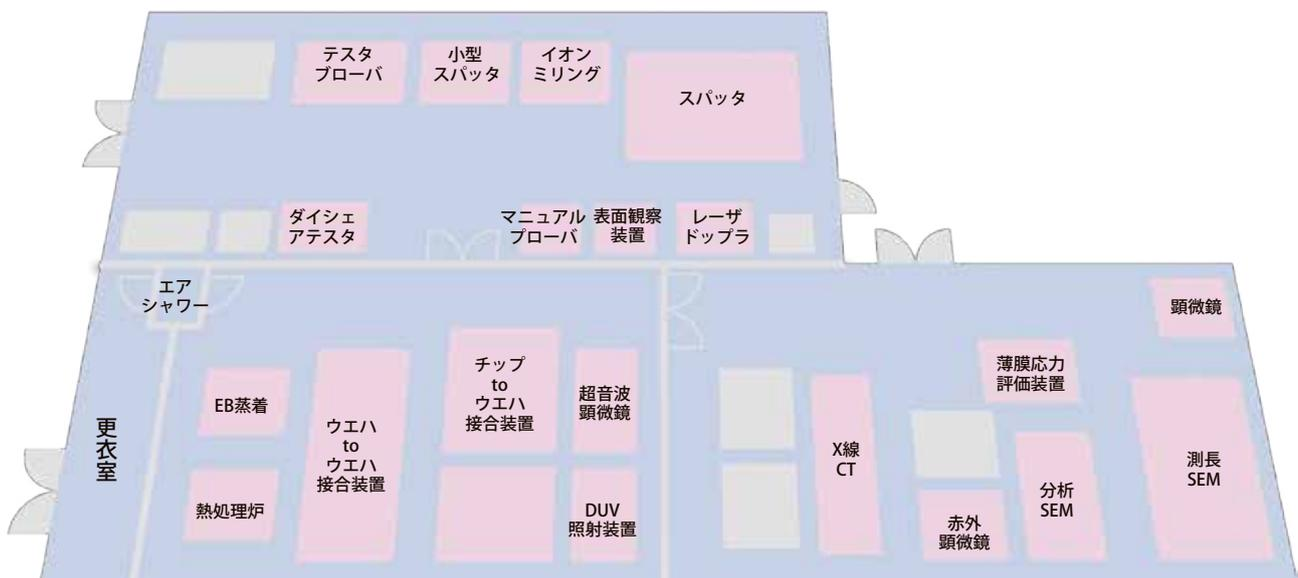
※これら二つのメインクリーンルームに加え、ダイシング関連を中心とした後工程設備やナノインプリント装置などをつくば中央事業所東地区のクリーンルームに設置し、MEMS加工施設として一体運用しています。
